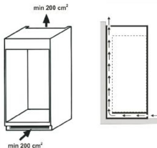
**Рисунок Б.5** - Схема циркуляции повітря навколо холодильного приладу
